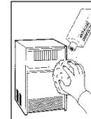
54 Nettoyer le bac de stockage avec une solution d'eau tiède mélangée avec un détergent léger. Rincer soigneusement puis passer toutes les parois intérieures avec une éponge imbibée d'un produit fongicide. Pour le nettoyage de la carrosserie il suffit de passer sur les surfaces un chiffon trempé avec un produit spécifique pour inox.
