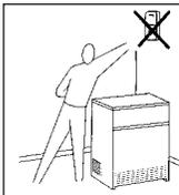
**7** L'interrupteur doit être facilement accessible et à proximité de l'appareil.
